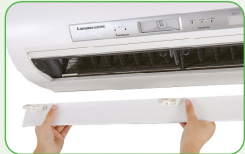
Bước 1: Tháo van thổi gió bằng cách bật nhẹ 2 chốt
